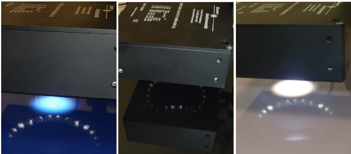
Измерение цвета на металлических пластинах сразу после нанесения покрытия с помощью SPECTRO-3-28-45°/0°-MSM-ANA-DL
